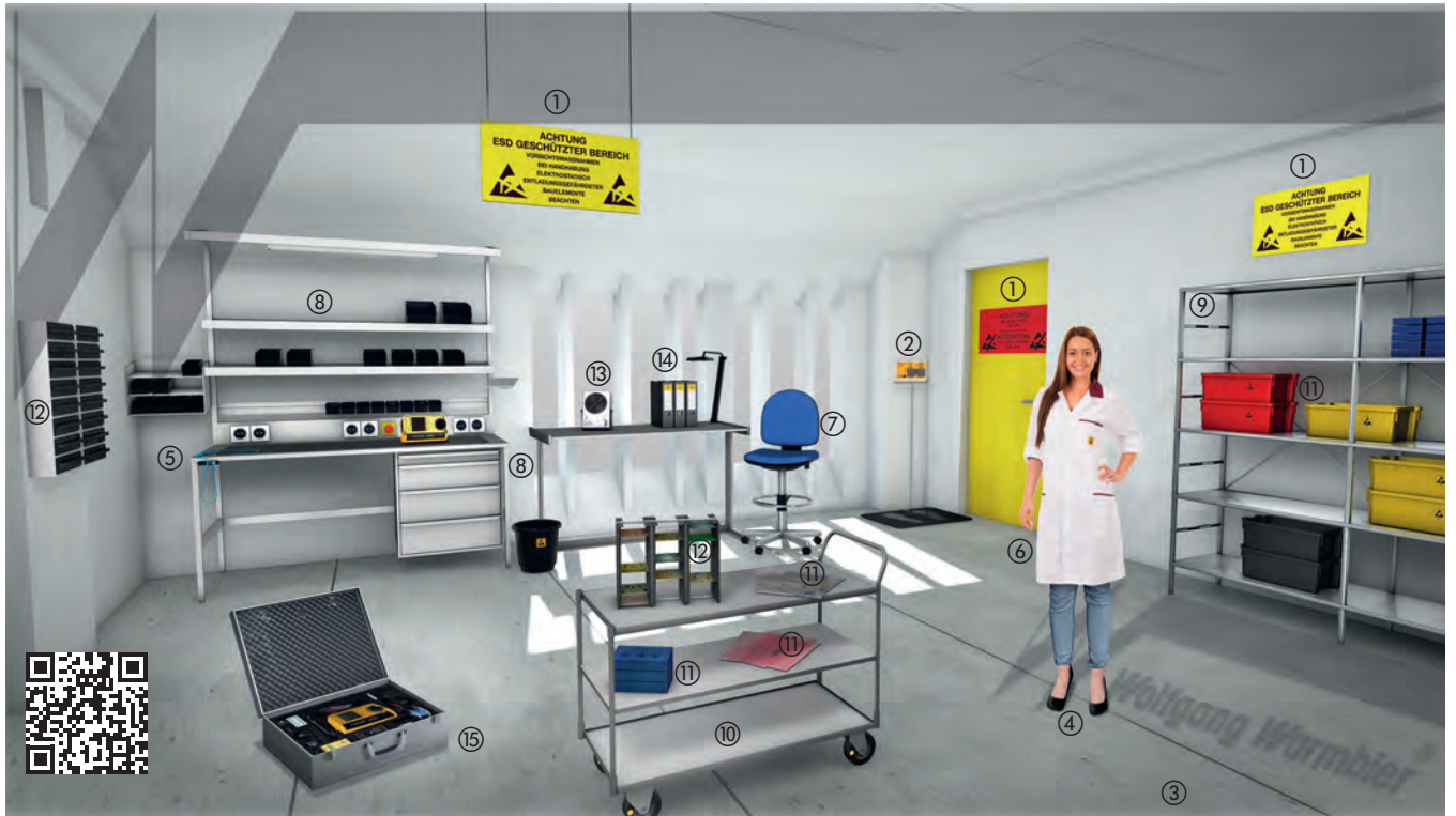
Exemple de configuration d'une zone protégée ESD
