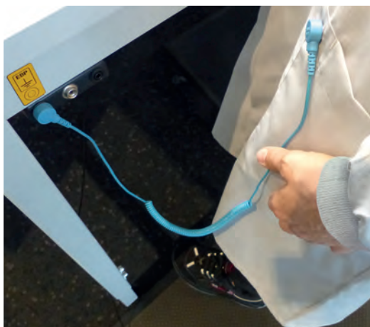
Mise à la terre à l'aide d'un cordon
