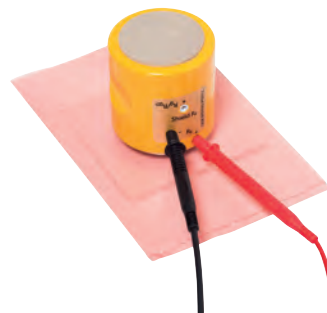
Exemple d'utilisation: mesure avec électrode concentrique
