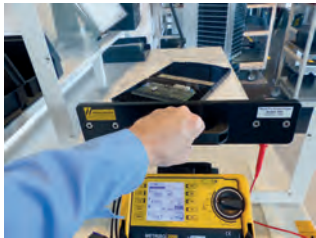
Exemple d'utilisation: mesure sur capot acrylique
